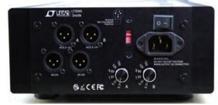
iCAT Audiophile Server/Player S,Rモデルのオプション500WリニアATX電源です。従来のPWR-L4シリーズのトランスや回路、パーツ品質および機能を見直し、ヒートシンクを大型化し熱特性を大幅改善し、より安定性とDC電源品質を高めました。大型の新オーディオ・トランス、高品質トランジスター、超大型10000uf ELNAオーディオキャップ、EMI/RFI Filter、低損失ケーブルを使用した、新世代のAudiophile ATX電源です。
